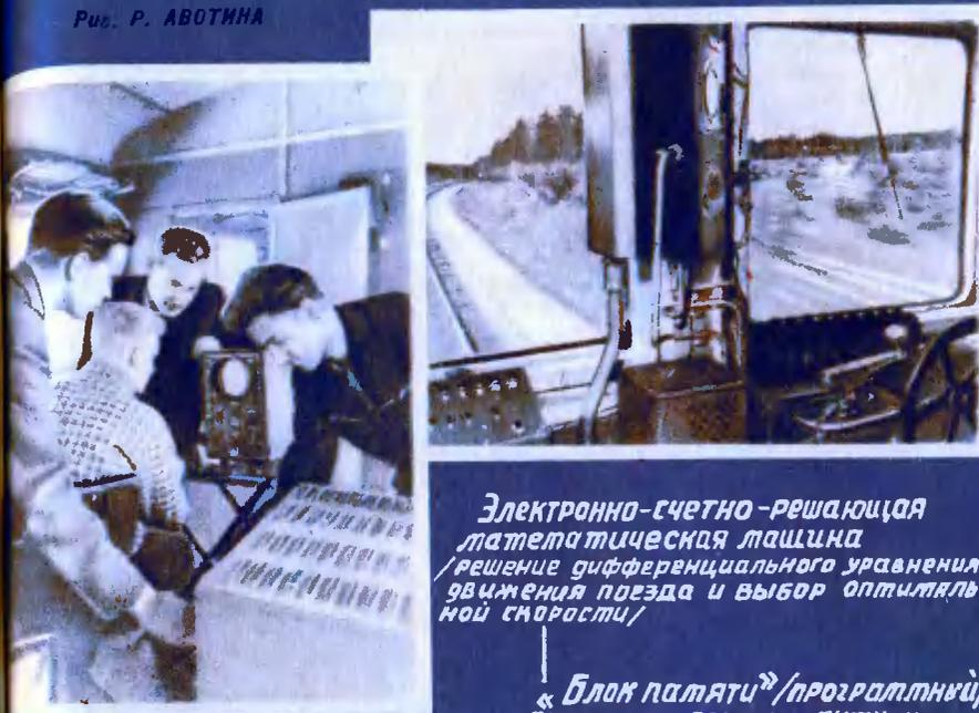
Электронно-счетно-решающая математическая машина / решение дифференциального уравнения движения поезда и выбор оптимальной скорости /
